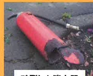
破裂した消火器
