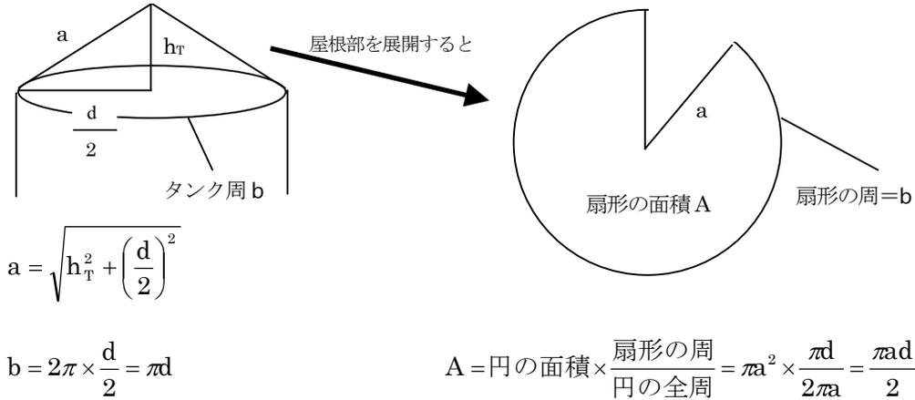
屋根板の重量  $[\text{kN}] = \text{扇形の面積} [\text{m}^2] \times \text{板厚} [\text{m}] \times \text{比重} \times \text{重力加速度} [\text{m/s}^2]$
