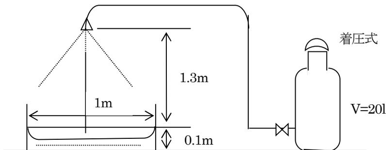
消火試験器材配置図
