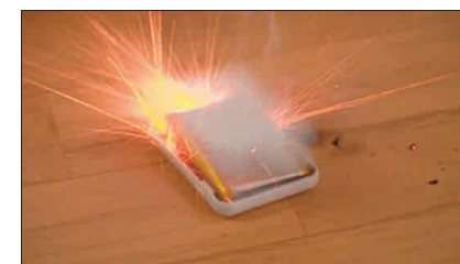
モバイルバッテリーから出火する様子 (出典：住宅における電気火災に係る防火安全検討会報告書)
