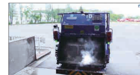
一般ごみとして捨てられたリチウムイオン電池が ごみ収集車内で押しつぶされ、出火する様子 (出典：独立行政法人 製品評価技術基盤機構Nite)
